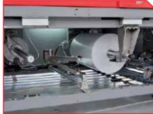
Saldatore con doppio portabobina film / Heat sealer with double film reel holder / Soldador con doble portabobina film / Soldador com duplo porta-bobina de película / Scelleuse avec double porte-bobine film / Siegelvorrichtung mit doppeltem Folienrollenhalter / Сварочный узел с двойным держателем пленки
