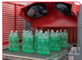
Sistema di raffreddamento regolabile / Adjustable cooling system / Sistema de enfriamiento regulable / Sistema de arrefecimento regulável / Système de refroidissement réglable / Einstellbares Kühlsystem / Регулируемая система охлаждения
