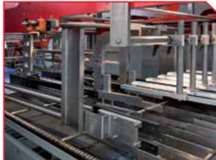
Separatori doppia e tripla pista / Double and triple lane separators / separador doble y triple pista / Separador dupla pista e pista tripla / Séparateurs à double et triple pistes / Separatoren für zwei- & dreibahnigen Betrieb der Maschine / Разделители двойной и тройной дорожки
