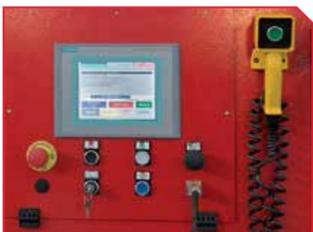
Touch screen con pen drive usb / Touch screen with usb pen drive / Touch screen con pen drive usb / Touch screen com pen drive USB / Ecran tactile avec clé USB / Touchscreen mit USB-Stick-Anschluss / Сенсорный экран с флеш-драйвом
