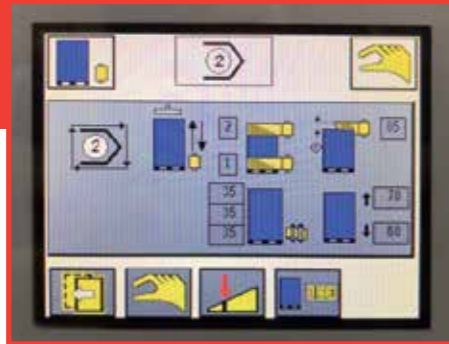
IT_ Quadro elettrico dotato di Display touch-screen nella versione di serie.
